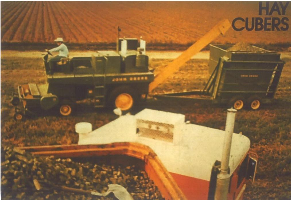
شكل رقم (٣٩): جهاز عمل مكعبات من المخاليط العلفية
