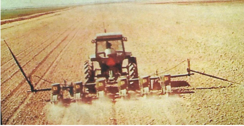
شكل رقم (٤٢) يوضح موقع المؤشرين لتحديد خطوط الزراعة
