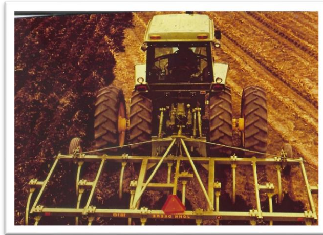
شكل رقم (٢٨) يوضح محراث حفار يرفع بالهيدروليك
