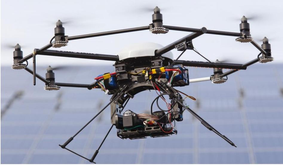
شكل 5- 10. لروبوت الطائرة كحامل لأشعة الليزر لمكافحة الأعشاب الطفيلية.
