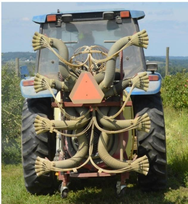
شكل 3- 16. جهاز رش ذكي يستخدم مزارع الفاكهة. كان جهاز للرش التقليدي مدعومًا بالهواء تم تجهيزه بنظام التحكم الذكي في الرش الموجه بالليزر والذي يتضمن مستشعر المسح بالليزر، ومستشعر السرعة، وجهاز التحكم التلقائي في معدل تدفق الفوهة، وجهاز كمبيوتر مدمج به خوارزميات، وشاشة تعمل باللمس، ومعدل متغير. فوهات مقترنة بصمام التحكم في التدفق المعدل بعرض النبضة على نظام توصيل متعدد المنافذ بمساعدة الهواء. Chen, et al. 2020.
