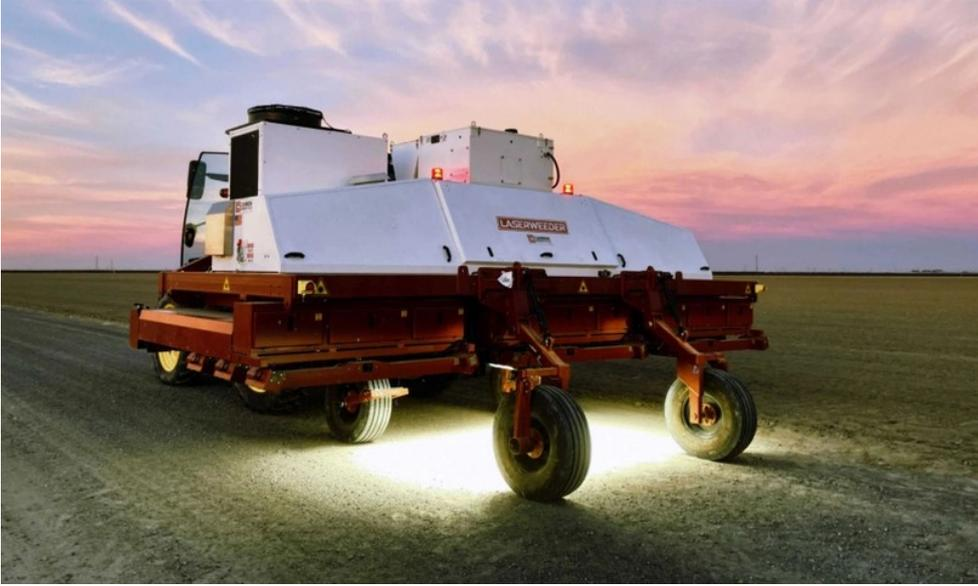
شكل 5- 11. جهاز ليزر الاعشاب LaserWeeder، يستخدم نظام Carbon Robotics الليزر والتحديد الدقيق لقتل الأعشاب الضارة. وكذلك لتخفيف المحاصيل الخالية من المواد الكيميائية.
