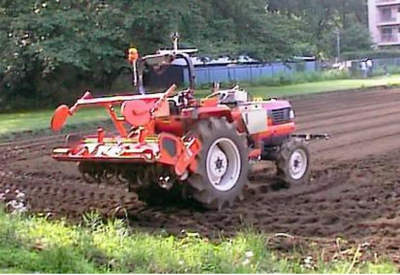
شكل 2-1. جرار زراعي ذاتي التوجيه بالليزر
